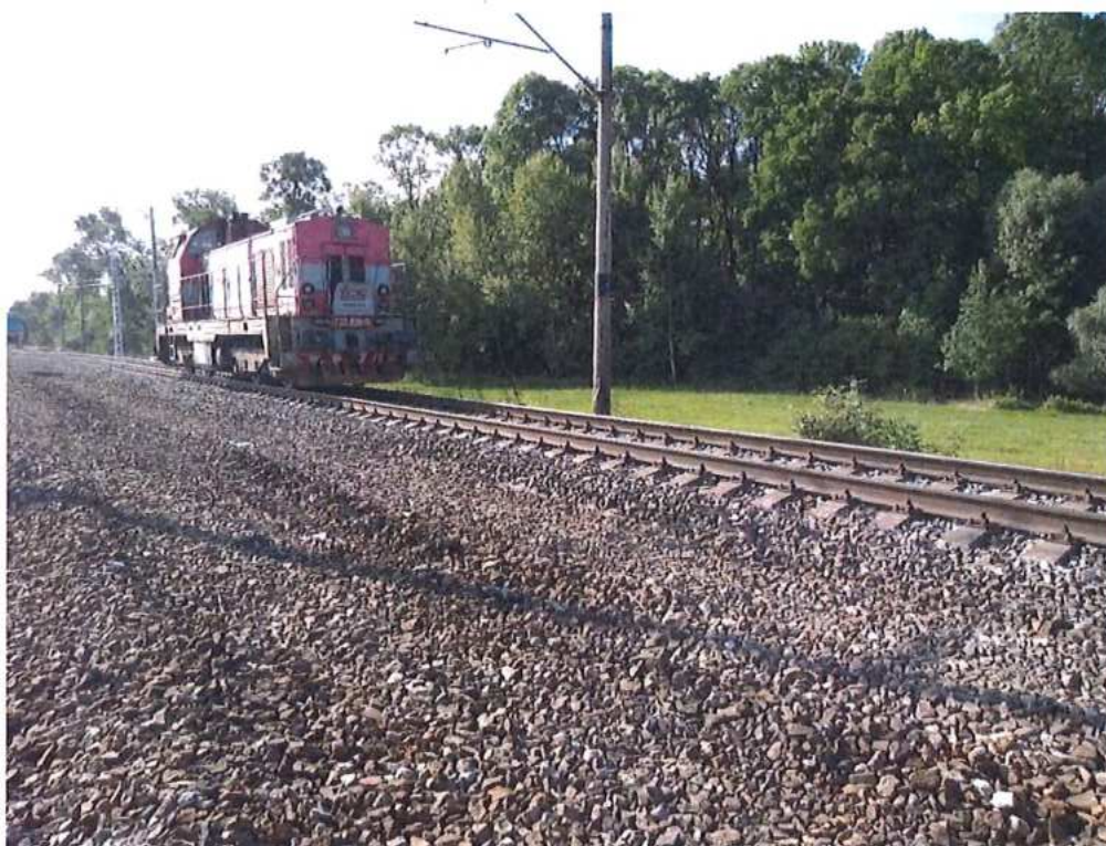
Skúšobná jazda cez „S“ prepojenie pred uvedením do prevádzky.
